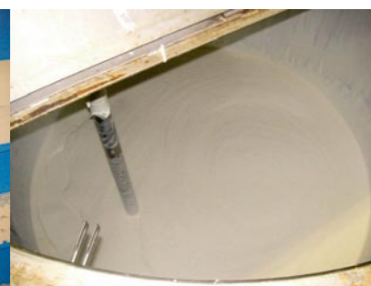
Een exact bepaalde mix van natuurlijke en synthetische latex wordt vermengd met lucht en net zo lang gemixed tot er een luchtig schuim ontstaat.
