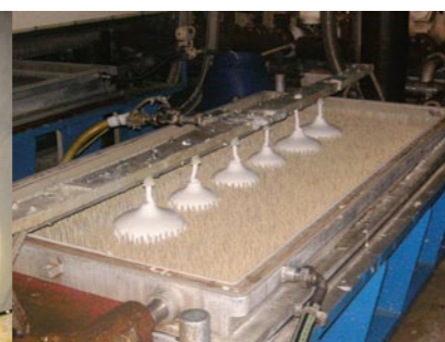
De matrijs wordt, afhankelijk van de gewenste hardheid, met de luchtige substantie gevuld.
