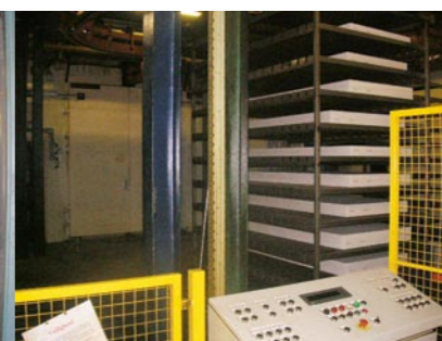
De vulcanisatie vindt plaats in een tunnel van 85 graden gedurende 8 uur.
