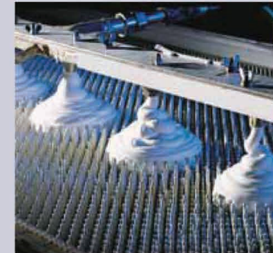
Vullen van de mal
